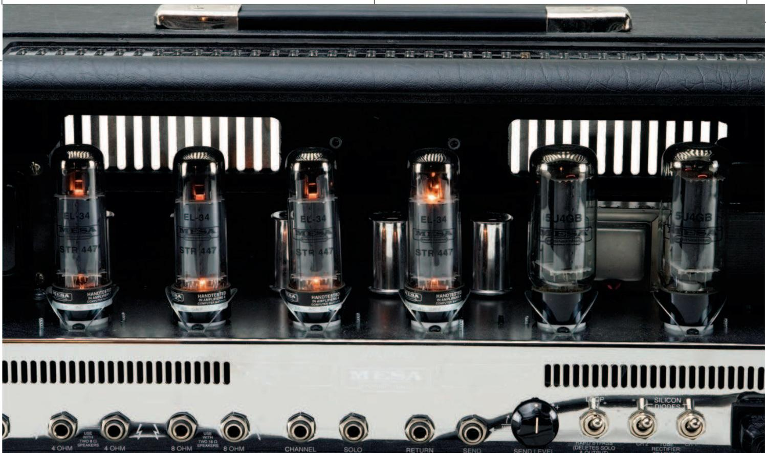
soit les deux tubes 5U4 (un en mode 50 watts), soit les diodes silicium. Une sortie « slave » réglable permet d'attaquer un autre système de sonorisation.
