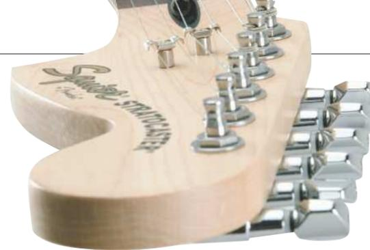
On distingue le trussrod dans la cavité à la base de la tête ; il permet de régler le manche.
